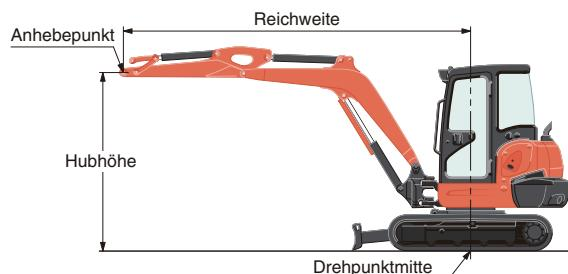
\* Die technischen Daten über den Arbeitsbereich der Maschine wurden mit dem Kubota Standard - Tieflöffel, ohne Schnellwechselsektion ermittelt.
